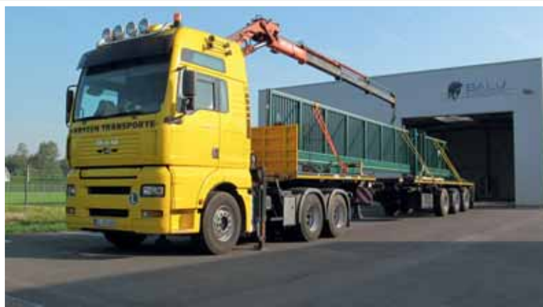
13 m Schiebetor, Transport mit Kranentladung und einteiliger Lieferung
