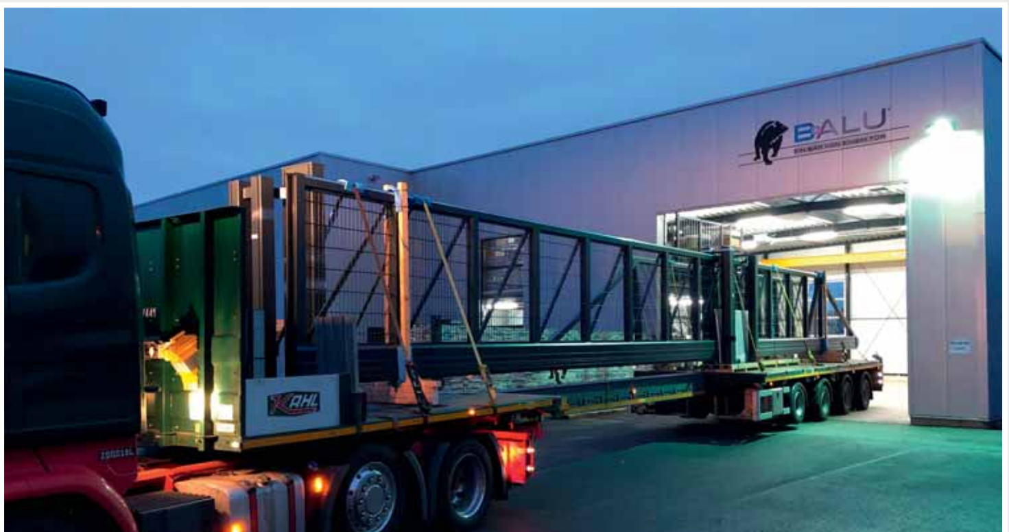
Schiebetor mit 15 m Pfostenlichte und 2 m Höhe zusammengebaut, 19,5 m Gesamtlänge, Doppelstabmatte 8/6/8, Masche 50/200, RAL 7016 Matt, Inline 160
