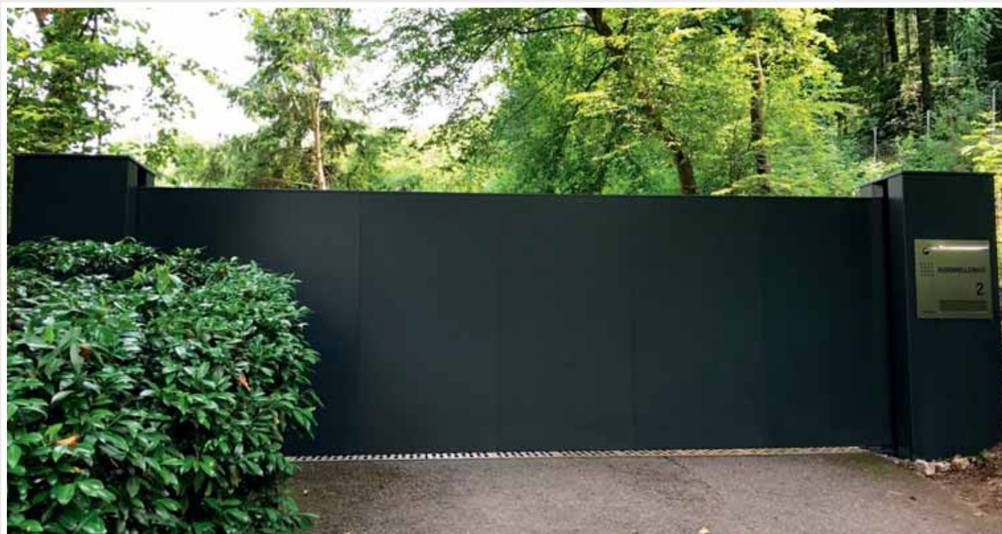
5,9 m Schiebetor, Glattblech vor die Laufschiene (Typ B8/B9) gesetzt, RAL 7016 Matt, Halte- und Einlaufpfosten als Sondersäule 750 mm breit, Fanggabel/Auflaufschuh in Einlaufpfosten integriert
