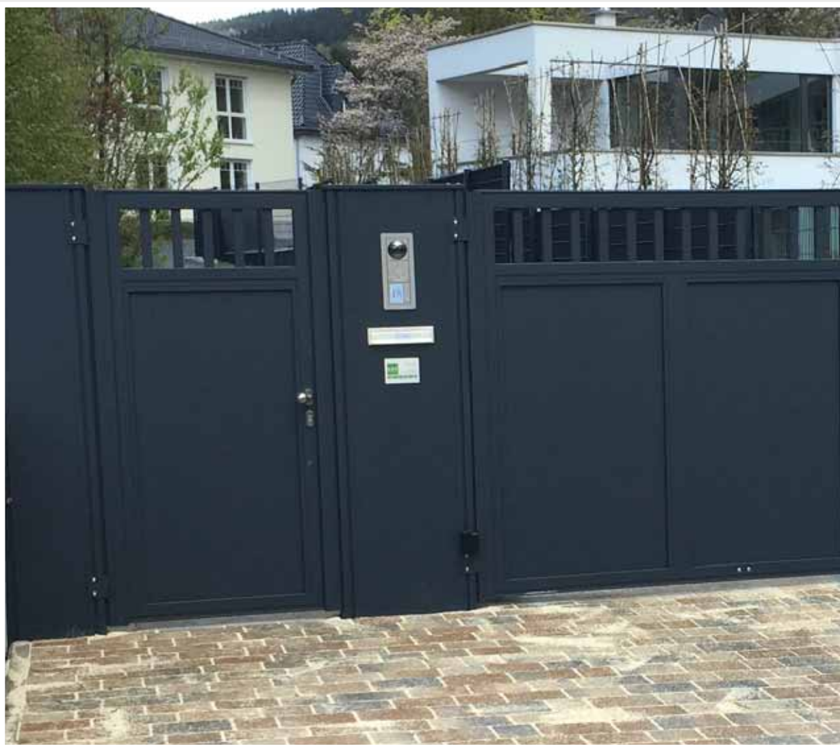
3,86 m Drehtor 2-flügelig, Glattblech mittig im Rahmen (Typ B1), oberhalb Profil 40/30, RAL 7016 Feinstruktur, Bedien- und Briefkastensäule als Halte- und Anschlagpfosten mit Anschlussstür
