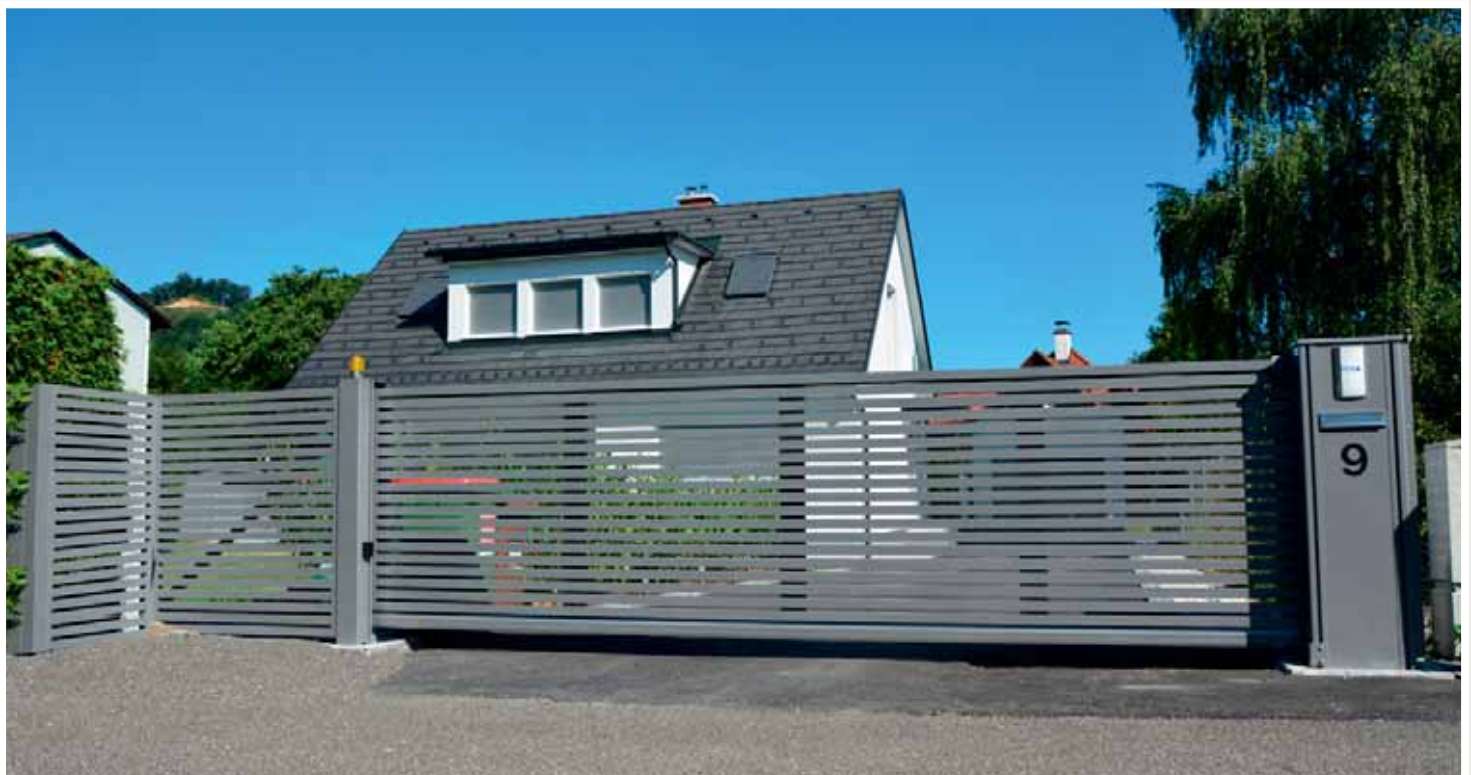
6 m Schiebetor, Amsterdam 80 außen vor den Rahmen, Extern 100, Briefkastensäule als Einlaufpfosten, Zaunfelder im Rückfahrbereich
