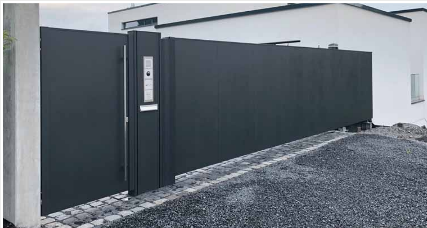
6 m Schiebetor, Glattblech vor die Laufschiene (Typ B8/B9) gesetzt, mit durchgehender Einlaufgabel und Briefkastensäule als Einlauf für Tor und Tür, gerade Abspannung mit Füllung und eingebauter Durchfahrtsbeleuchtung
