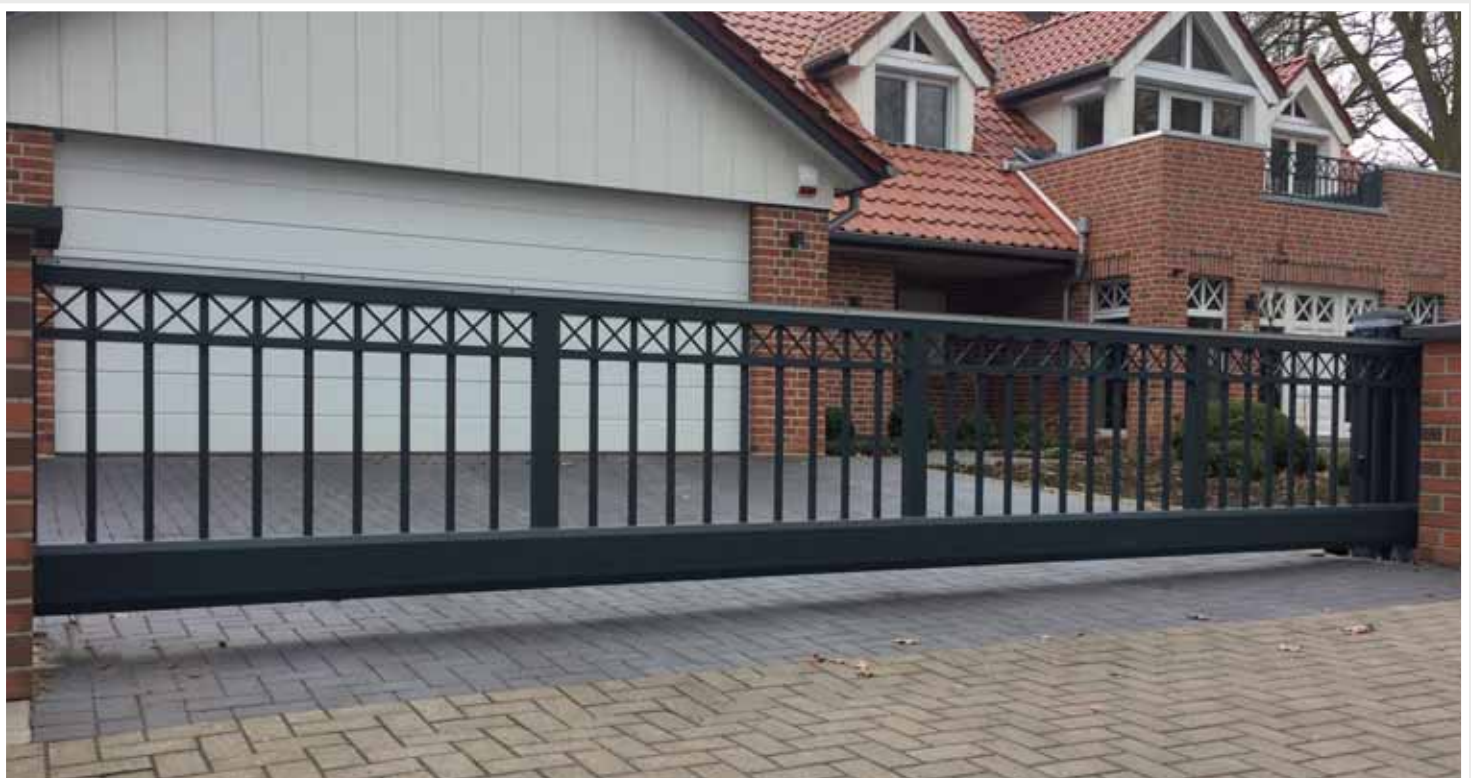
6,2 m Schiebetor, 1,1 m Höhe, Profil 25/20 inkl. Kreuzornamente, RAL 7016 Feinstruktur, Inline 100 auf der Hofinnenseite
