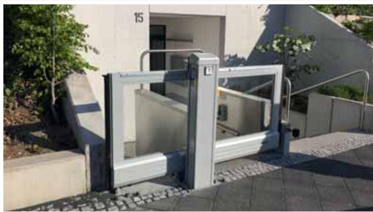
1,05 m Schiebetor für Rollstuhllift, Klarglasfüllung, RAL 9006 Seiden, Inline 100, ohne Einlaufpfosten
