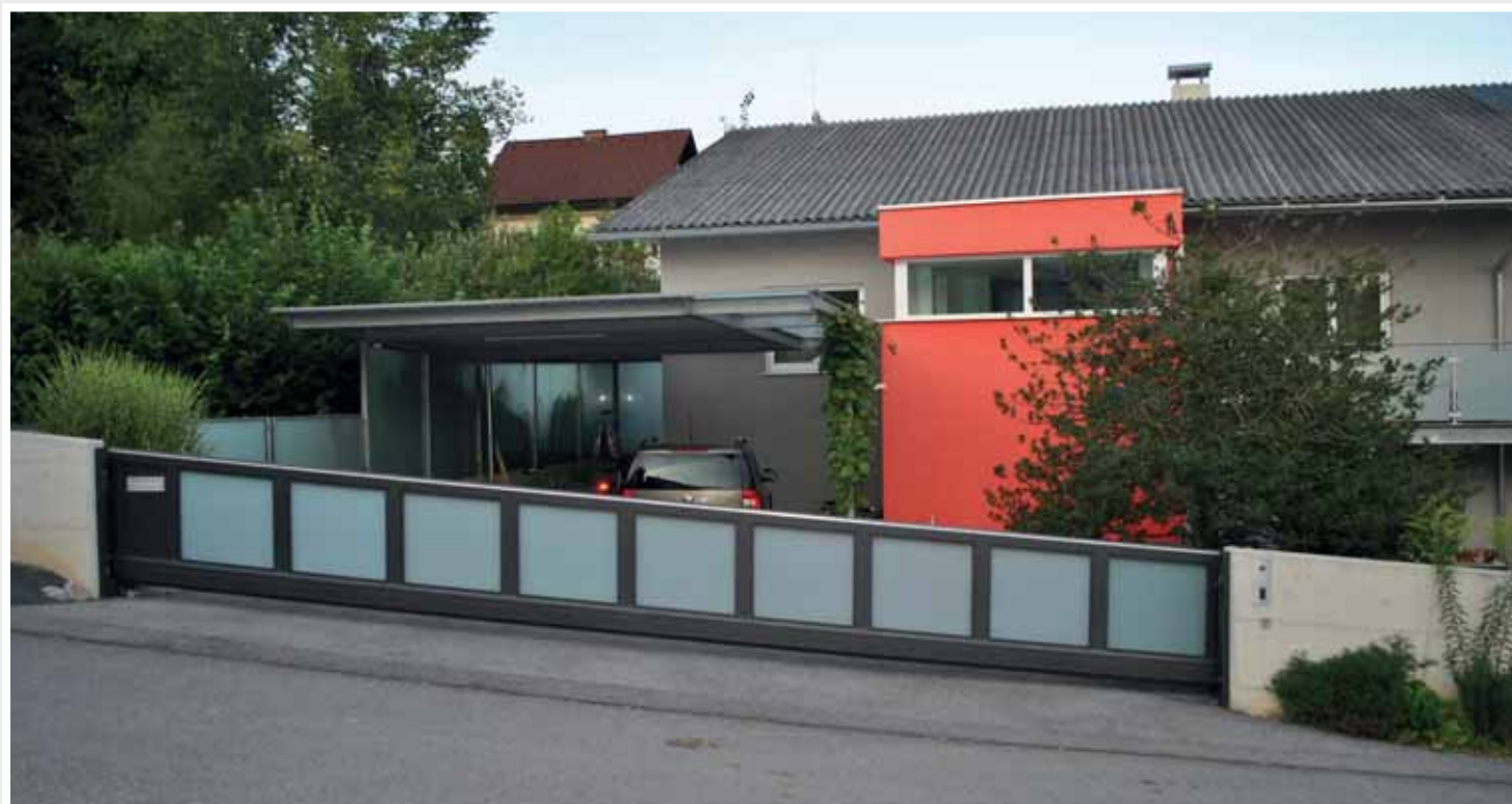
9 m Schiebetor, Füllung Milchglas, oben und unten schräg mit 900 mm Höhenunterschied gefertigt, im Torblatt integrierter Briefkasten mit rückseitiger Entnahme
