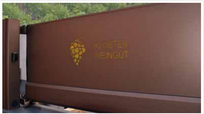
3 m Schiebetor, Glattblech vor den Rahmen (Typ B4/B5) gesetzt, Firmenlogo ausgelasert und beleuchtet, Corten Imitatfarbe
