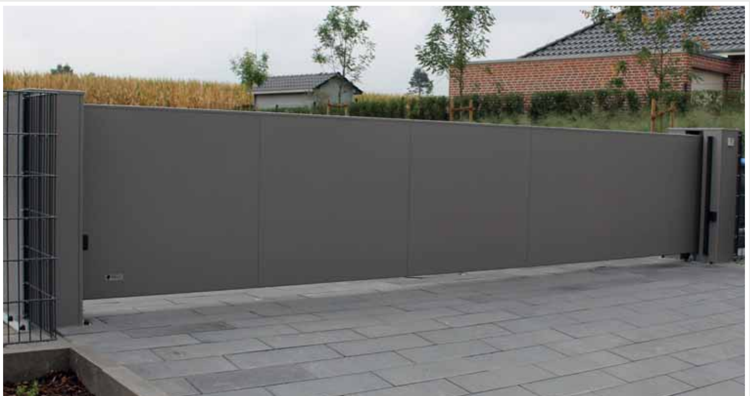
7 m Schiebetor, Glattblech vor die Laufschiene (Typ B8/B9) gesetzt, Oberfläche grau DB 702, Halte- und Einlaufpfosten als Sondersäule 300 mm breit, Fanggabel/Auflaufschuh in Einlaufpfosten integriert
